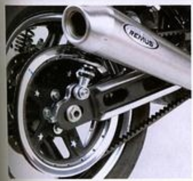
Bling Bling: Zusätzlich zum Motor polierte Bernie auch die Felgenhörner und das Pulley
